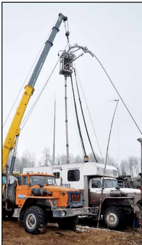
Проведение гидроразрыва пластов с использованием колтюбинговой технологии (гибкой трубы), 2013 год.
