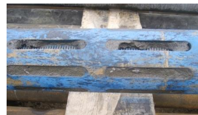
ГАЗОПЕСОЧНЫЙ ЯКОРЬ (ПРИЕМНАЯ СЕТКА ЗАБИТА ГЛИНИСТЫМ РАСТВОРОМ)
