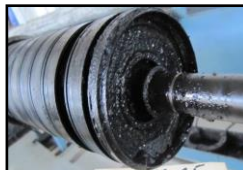
Износ рабочих колес ЭЦН
